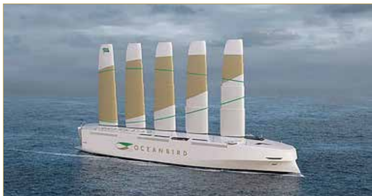
أكمل المصممون بشركة والينيوس مارين في ستوكهولم التجارب البحرية بنجاح لنموذج طوله 6 أمتار استعدادا لبناء السفينة الحقيقية بطول 200 متر وعرض 40 مترا.
